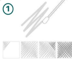
① Für Oberflächenbeprobungen das Extraktionsröhrchen bis zur Verschlussunterkante mit Extraktionspuffer füllen. Einen Tupfer mit dem Puffer anfeuchten und einen Bereich von ca. 5 x 5 cm im Kreuzstrichverfahren und ständigem Drehen beproben.
